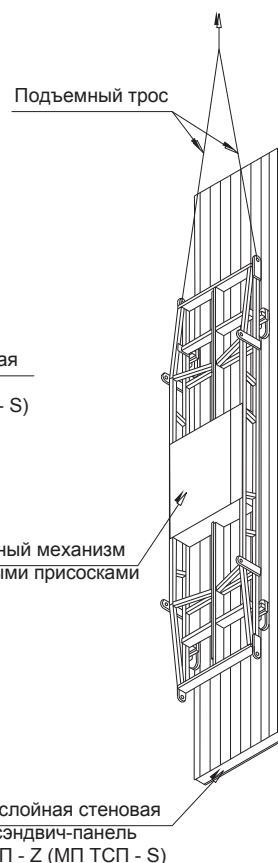
Схема строповки при вертикальной раскладке сэндвич-панелей
