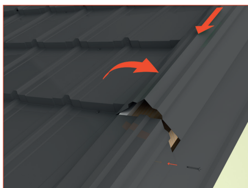
16. Схема монтажа торцевой планки
