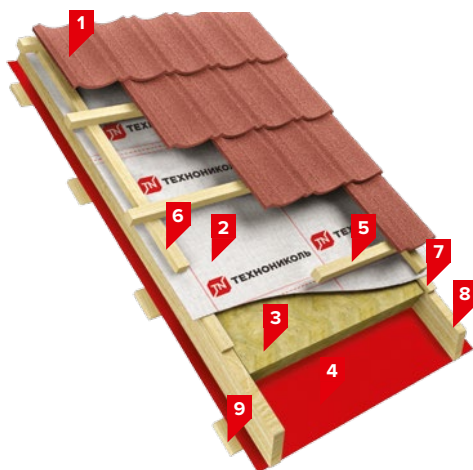
Рис. 6. Строение кровельной системы ТН-ЛЮКСАРД Мансарда
