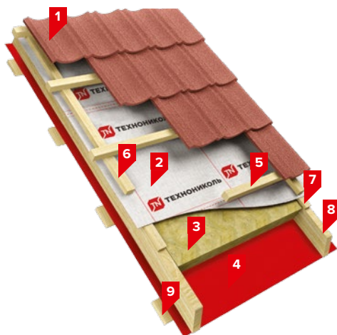
Рис. 6. Строение кровельной системы ТН-ЛЮКСАРД Мансарда
