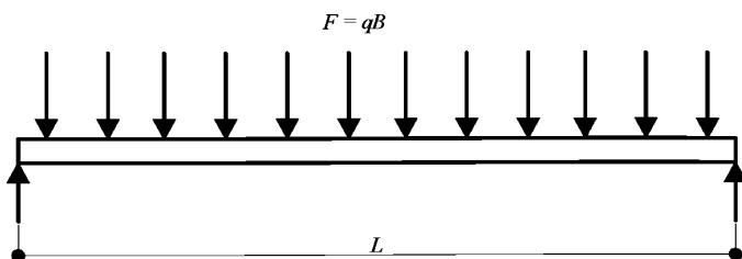
Рисунок Б.3 – Воздействие воздушного давления или вакуума
