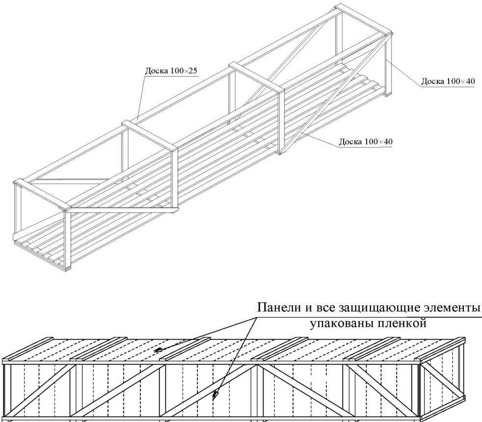
Рисунок А.3 – Пример деревянного контейнера решетчатого типа
