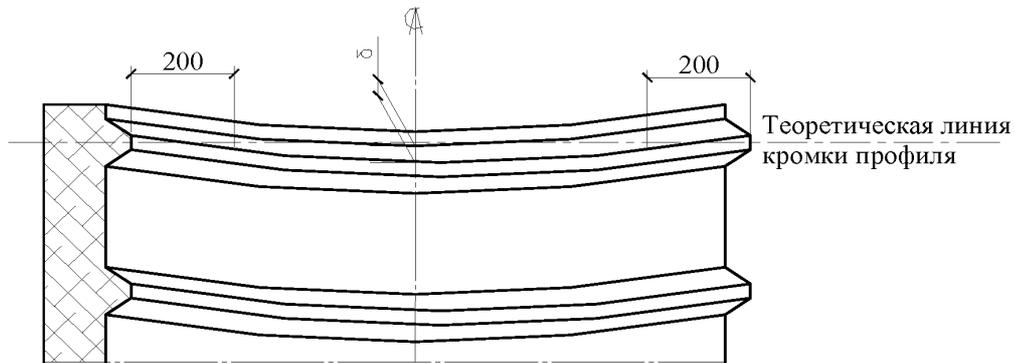
Рисунок 13 – Схема измерения серповидности
