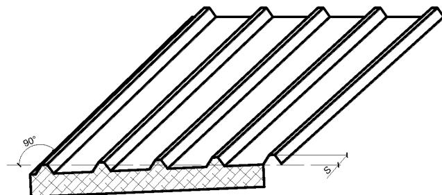
Рисунок 12 – Схема измерения отклонения от прямоугольности торцов
