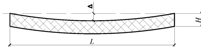
Рисунок 14 – Схема измерения прогиба панели
