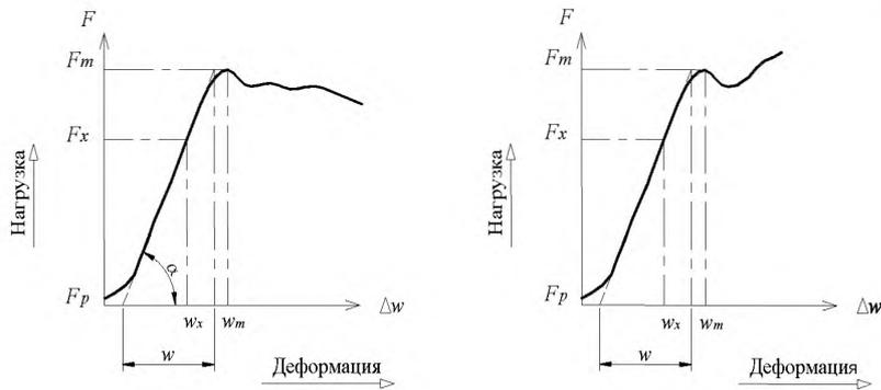
$F_p$  – сила, соответствующая предварительному нагружению;  $F_x$  – текущее значение силы, соответствующее определенной деформации;  $F_m$  – максимальная сила при разрушении;  $w_x$  – текущая деформация образца;  $w_m$  – деформация образца при действии максимальной силы;  $w$  – условная деформация образца при действии максимальной силы;  $\alpha$  – угол наклона условного прямолинейного участка диаграммы
