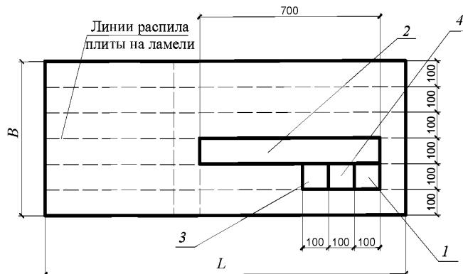
1 – образец для испытаний на плотность  $100 \times 100 \times h$ ; 2 – образец для испытаний на сдвиг  $700 \times 100 \times h$ ; 3 – образец для испытаний на сжатие  $100 \times 100 \times 100$ ;
