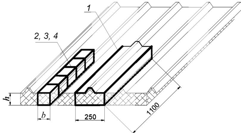
1 – зона вырезки образца для испытаний прочности на поперечный изгиб; 2 – зона вырезки образца для испытаний прочности на сжатие; 3 – зона вырезки образца для испытания прочности на растяжение; 4 – зона вырезки образца для определения физических свойств сердцевины (объемная масса, влаго- и водопоглощение, теплопроводность и др.)
