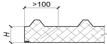
Рисунок 10 – Схема измерения толщины панели
