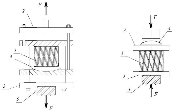
а) Схема нагружения образца
