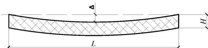
Рисунок 14 – Схема измерения прогиба панели
