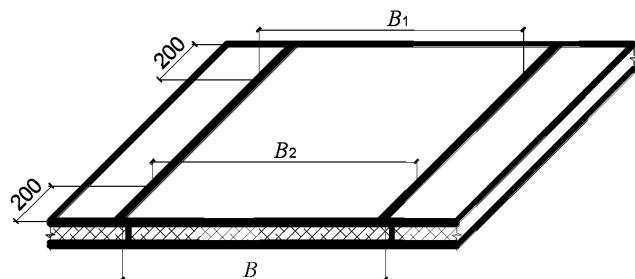
б) Схема измерения рабочей ширины стеновой панели
