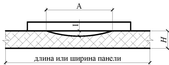
Рисунок 16 – Схема измерения отклонения от плоскости
