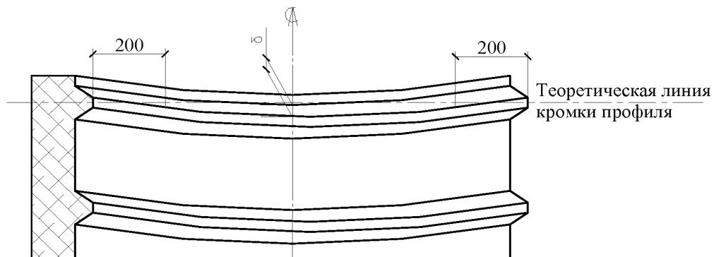
Рисунок 13 – Схема измерения серповидности
