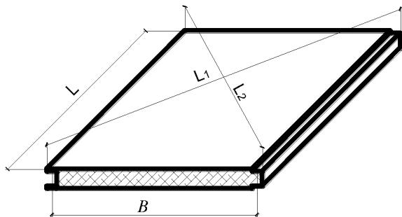
Рисунок 11 – Схема измерения косины реза панели
