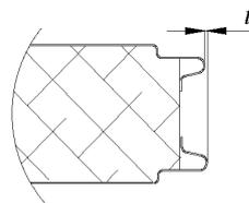
Рисунок 15 – Схема измерения смещения продольных кромок
