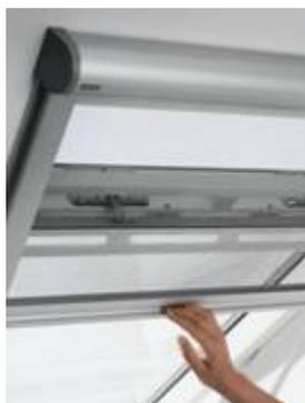
**Москитная сетка** устанавливается со стороны помещения на оконные откосы. Сетка двигается по направляющим и убирается в корпус над верхним оконным откосом. Для подбора сетки необходимо знать два параметра: размер окна и расстояние между оконными откосами (левым/правым, верхним/нижним).
